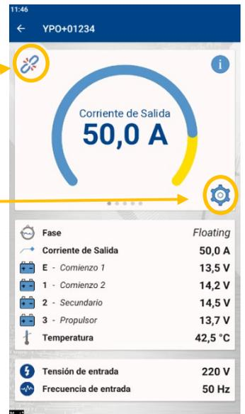
En la parte superior, puede desplazarse por la información sobre el voltaje y corriente de las diferentes baterías recorriendo la parte superior de la pantalla:
