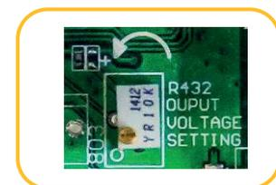
En caso de baterías especiales, recurrir a un instalador profesional que efectuará los ajustes particulares de acuerdo con las especificaciones del fabricante de baterías y teniendo en cuenta las particularidades de la instalación.
