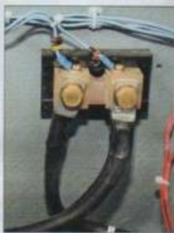
La mesure à haute précision du courant transitant dans le shunt permet au contrôleur de calculer toutes les données de charge et de consommation.
