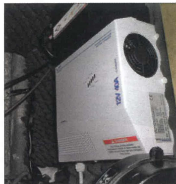
Le fonctionnement du chargeur dégage de la chaleur et une bonne aération de son compartiment est indispensable.
