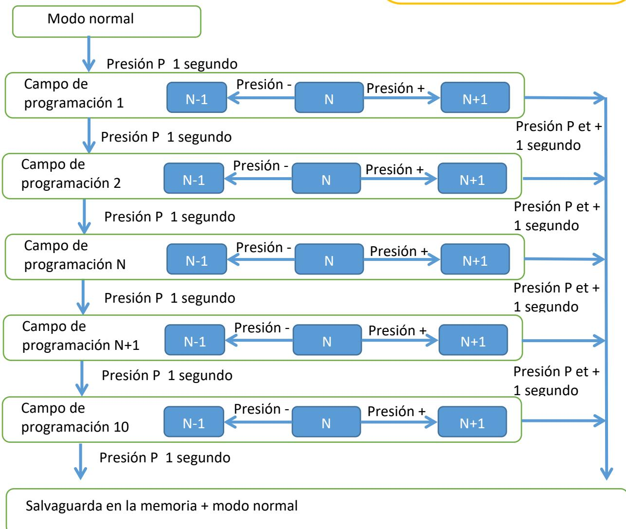
En modo programación, la cantidad de flashes sobre la LED "ON" indica el campo de programación, la cantidad de flashes sobre la LED "Floating/Refresh" indica el valor de programación N.
