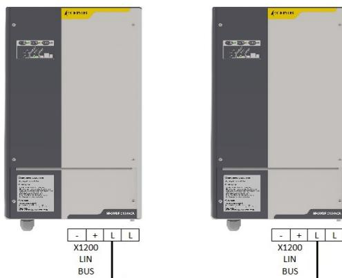
**Etape 3 :** **Choisir un identifiant par chargeur :** un seul chargeur doit être désigné maître. Son identifiant doit être compris entre 0 et 12. L'identifiant de l'esclave doit être le n°13, le n°14 ou le n°15 (Micro-interrupteurs 1, 2, 3 et 4 – repère SW1202) ;
