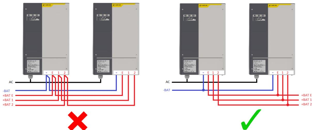
**Etape 2 :** **Raccorder la commande :** Le câble de parallélisation doit relier les broches L des connecteurs X1200 de chaque chargeur. Un fil unique, gainé, multibrins de section 1 mm<sup>2</sup> est utilisé. Sa longueur entre les deux chargeurs ne doit pas excéder 1 mètre.
