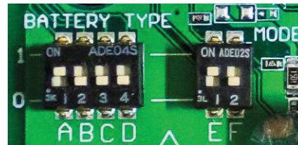
Diese Konfiguration ist ein Kompromiss, der das zufriedenstellende Laden verschiedener Batterie-Typen mit verschiedenen Technologien, (gemischt oder nicht) ermöglicht. :
