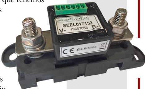
La derivación de 300 A debe instalarse en la línea negativa
