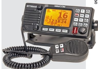
Este nuevo modelo de VHF se ofrece en dos versiones, sin GPS o con GPS y AIS interno. El modelo sin GPS tiene una entrada de GPS (NMEA0183) y también es compatible con la antena de GPS plug & play (opción). Tiene una pantalla grande para lectura remota y ofrece una visualización clara de objetivos AIS (modelo RT750 AIS). Ambos modelos tienen una salida de altavoz o megáfono.
