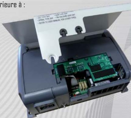
La carte interface BUS-CAN permet au chargeur de communiquer avec un système de monitoring ou avec tout autre périphérique fonctionnant avec ce mode de communication. Le protocole peut être adapté sur mesure à la demande.<sup>(2)</sup>
